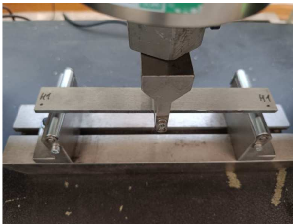
Рисунок 6 – Установка образца на испытательной машине Kason WDW-50
