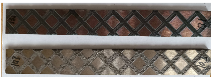
Рисунок 4 – Поверхность образцов 11.3, 13.1 (закалка) и 8.1, 10.3 (борирование) после лазерной обработки
