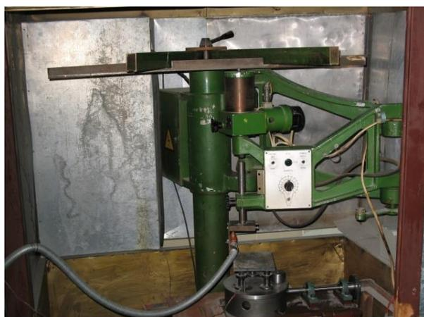
*Рисунок 1 – Экспериментальная установка для поверхностного плазменного упрочнения*
