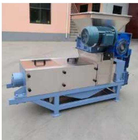
*Рисунок 1 – Комплект оборудования для плавки битого пластика*
