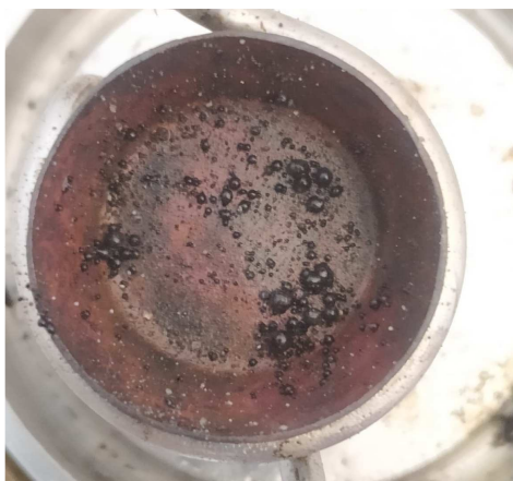
Рисунок 6 – Вид золы после сжигания топлива с использованием ОСВ марки 4
