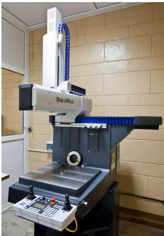
*Рисунок 1 – Координатно-измерительная машина DuraMax 5/5/5*
