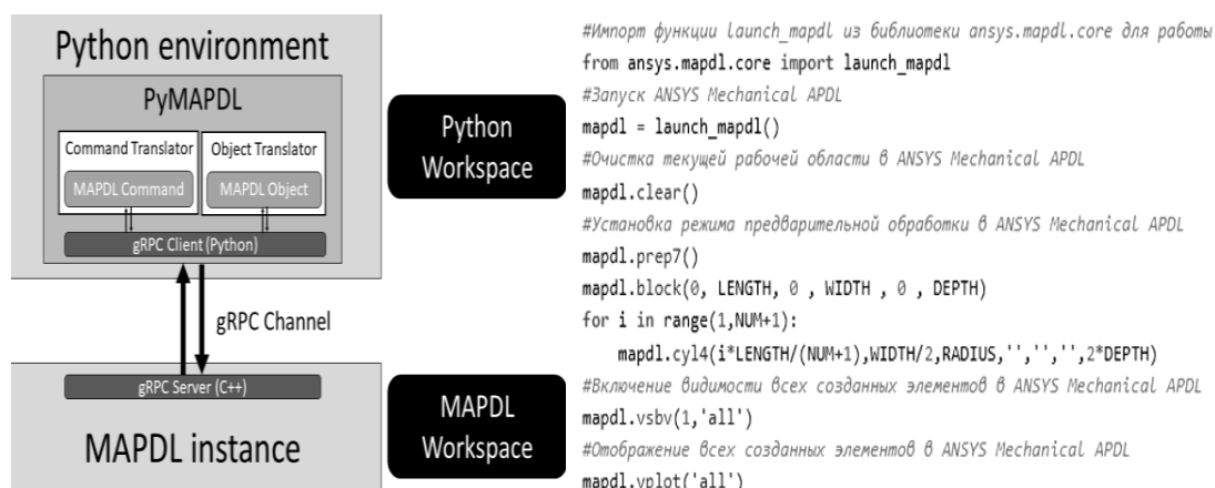
Рисунок 1 – Архитектура PyMAPDL (слева) Фрагмент кода в задаче расчета пластины (справа)
