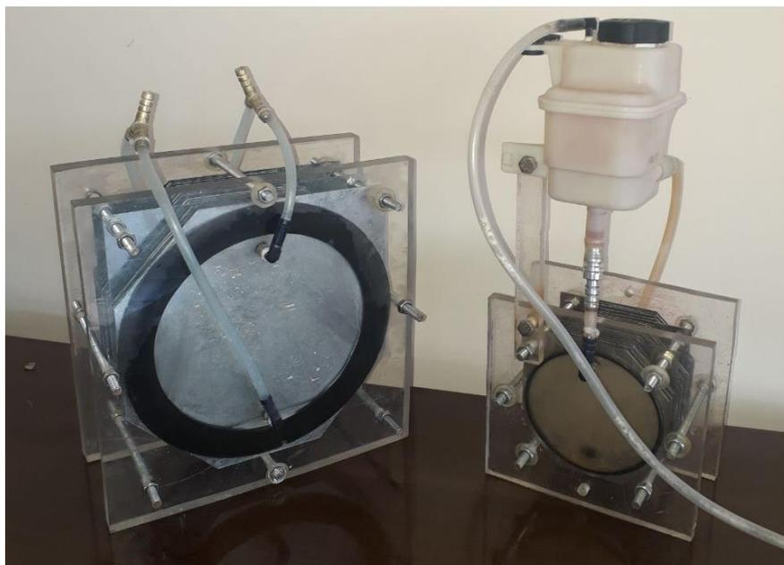
*Рис. 1. Электролизеры для грузового и легкового автомобилей*
