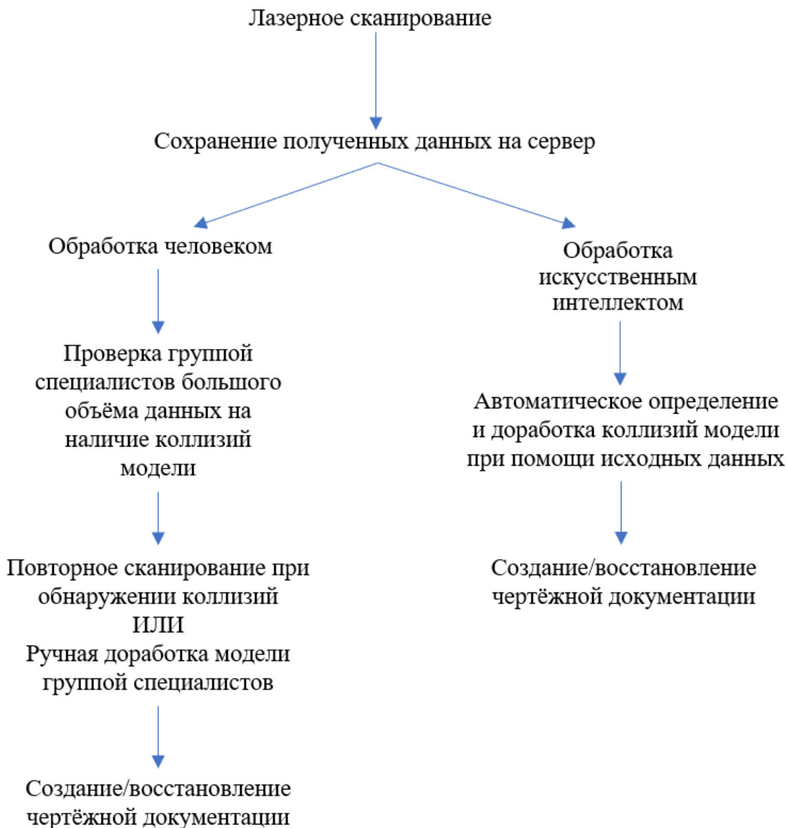
Рисунок 2 – Демонстрация различия ведения рабочих процессов технологии лазерного сканирования с/без интегрированного искусственного интеллекта
