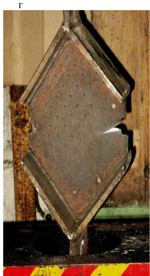
а – образцы ЭПС перед испытанием; б – вид образца типа ЭПС с активным элементом без конструктивных концентраторов; в – вид образца типа ЭПС с отверстием в середине активного элемента; г – вид образца типа ЭПС с боковыми вырезами в активном элементе
