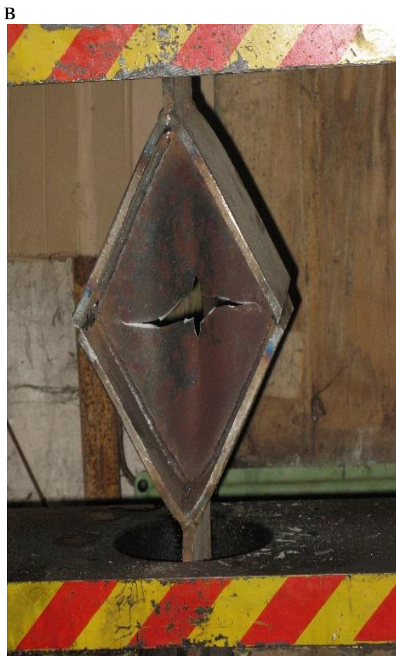
а – образцы ЭПС перед испытанием; б – вид образца типа ЭПС с активным элементом без конструктивных концентраторов; в – вид образца типа ЭПС с отверстием в середине активного элемента; г – вид образца типа ЭПС с боковыми вырезами в активном элементе
