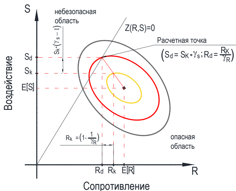
Рисунок 3 – Взаимосвязь между средними характеристическими и расчетными значениями
