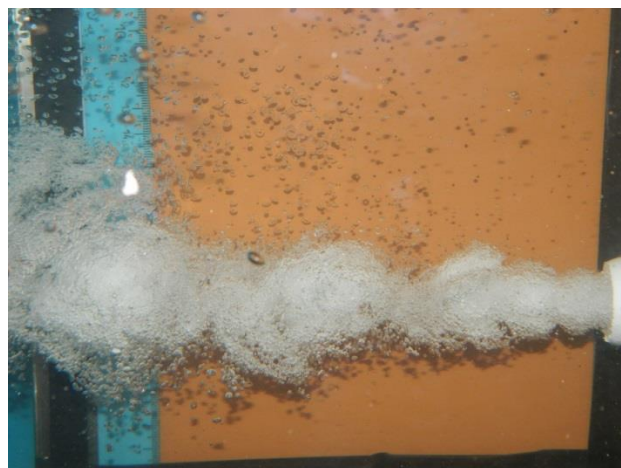
Рисунок 8 – Газожидкостная струя, полученная в опыте № 1
