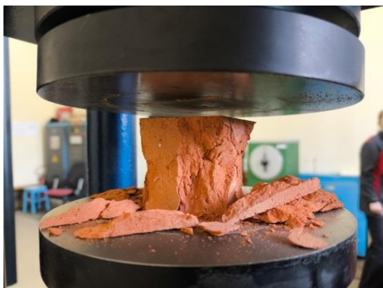
Рисунок 5 – Характер разрушения опытных образцов
