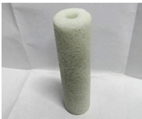
Рисунок 7 – Пористый элемент с порами от 0,2 до 0,3 мм, имеющим наружный диаметр 45 мм и цилиндрическое отверстие диаметром 12 мм по всей длине
