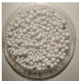
Рисунок 5 – Зерна полистирола, вспененного горячей водой
