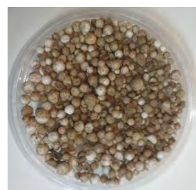
Рисунок 6 – Зерна полистирола, вспененного в среде горячего зернистого материала
