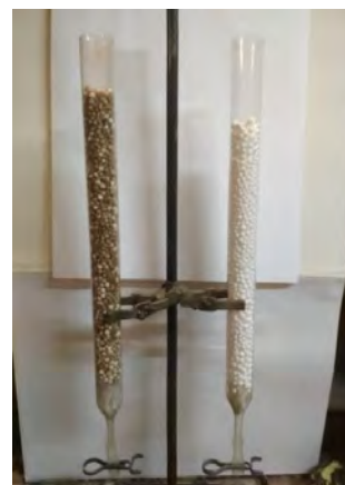
Рисунок 7 – Зерна полистирола, вспененного в среде горячего зернистого материала и в горячей воде
