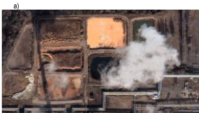
а – пруды-шламонакопители на Минской ТЭЦ-4 вид со спутника по данным интернет-ресурса Google Карты (масштаб – 1:100 м); б – фотография шлама химводоочистки Минской ТЭЦ-4 РУП «Минскэнерго»
