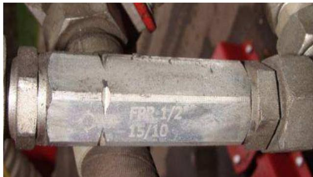
Рисунок 4 – Обратный клапан
