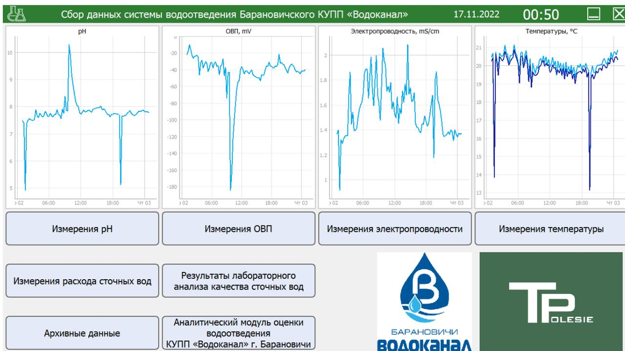
Рисунок 1 – Интерфейс компьютерно-интегрированной системы сбора информации о качестве сточных вод
