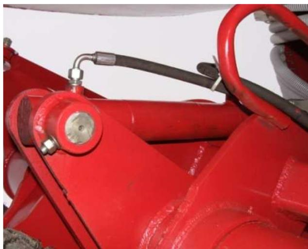
Рисунок 9 – Гидроцилиндры поднятия и опускания пакерных катков
