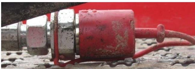
Рисунок 2 – Муфта с условным проходом DN25
