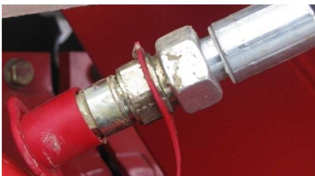
Рисунок 3 – Муфта с условным проходом DN13
