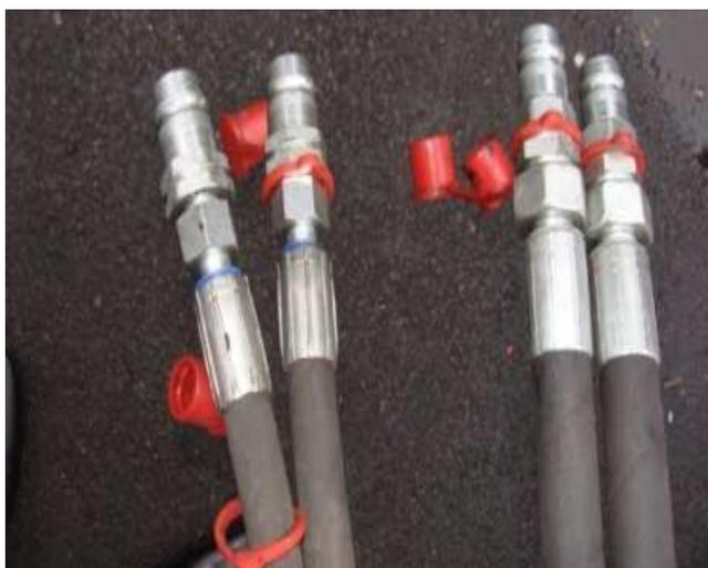
Рисунок 7 – Пары гидравлических рукавов
