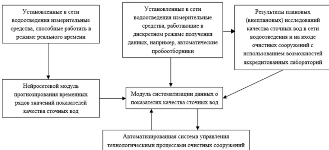
Рисунок 10 – Возможная структура системы предиктивного управления процессом очистки сточных вод с использованием нейросетевого прогнозирования значений показателей качества
