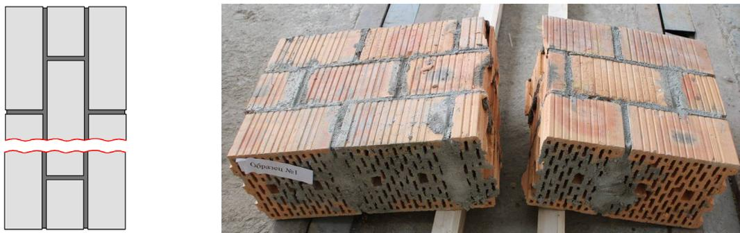
Рисунок 5 – Характер разрушения опытных образцов серии ИП-2
