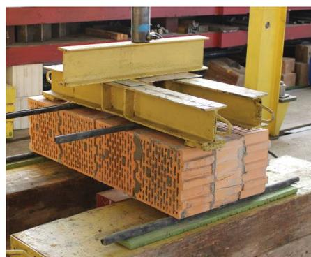
а) – определение значения  $f_{x1}$ ; б) – определение значения  $f_{x2}$
