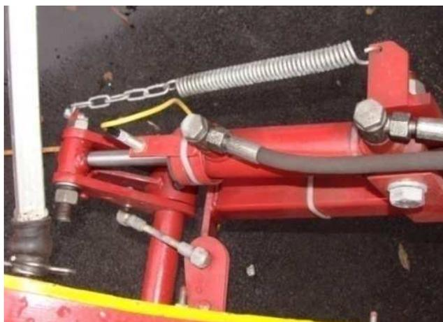
Рисунок 11 – Гидроцилиндр приводного колеса
