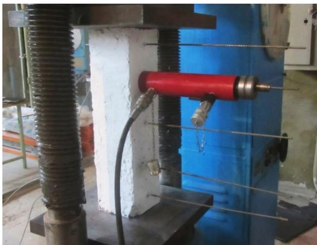
Рисунок 3 – Общий вид испытаний на выдергивание проволочной арматуры из бетона опытных образцов-призм
