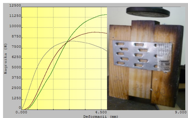
Рисунок 5 – Результаты и характер разрушения образцов серии V
