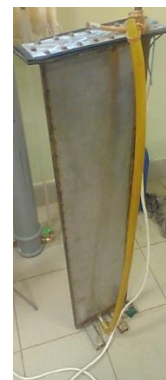
Рисунок 5 – Внешний вид экспериментального электролизного блока получения гипохлорита натрия из обработанной сточной воды рыбоперерабатывающего предприятия (с возможностью работы с загрязнённым водным раствором)
