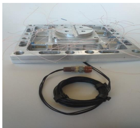
Рисунок 4 – Чувствительный элемент датчика с тензорезисторами. Вид сверху
