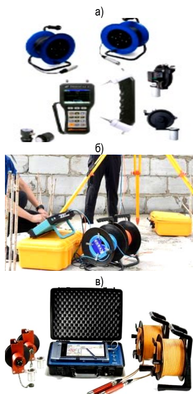
а) «ДБС-1», «Интерприбор» (Россия); б) «Ultra Sonic Pile Integrity Tester», «Sinoroock»(Китай); в) «Cross Hole Ultrasonic Monitor», «Piletest» (Израиль, Великобритания)
