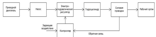
Рисунок 1 – Структурная схема электрогидравлической системы управления рабочими органами
