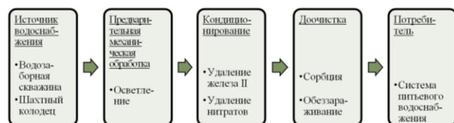
Рисунок 1 – Блок-схема водоподготовки для удаления нитратов
