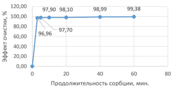
Рисунок 4 – Зависимость эффекта сорбции ионов Pb<sup>2+</sup> от продолжительности контакта
