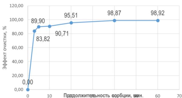
Рисунок 5 – Зависимость эффекта сорбции ионов Cu<sup>2+</sup> от продолжительности контакта
