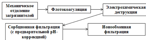
Рисунок 2 – Технологическая схема реализации очистки высококонцентрированных сточных вод рыбоперерабатывающего предприятия
