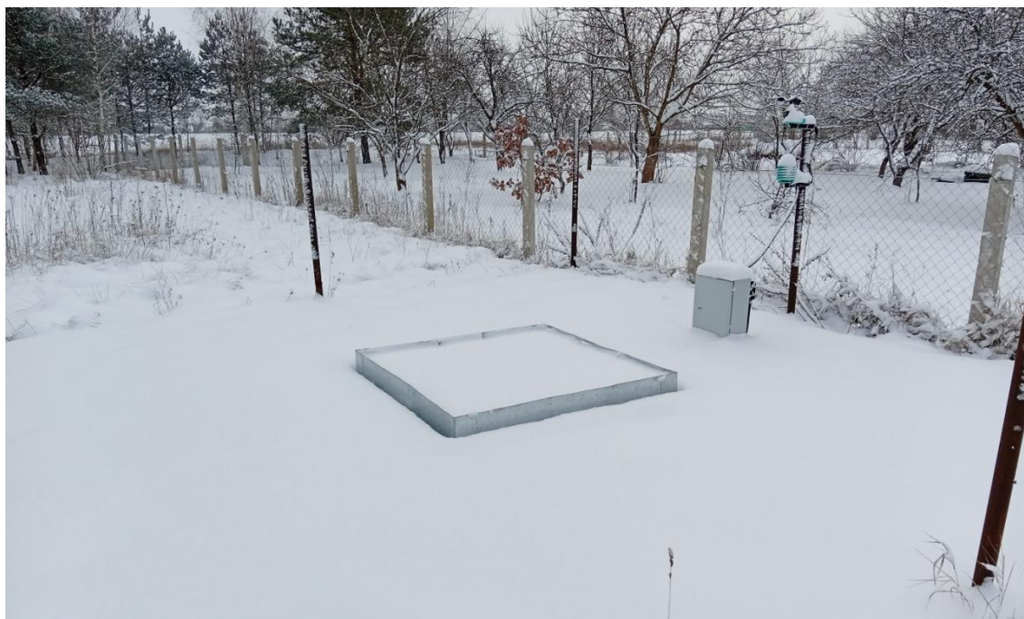
Рисунок 1 – Площадка № 1. Установка для измерения массы снега
