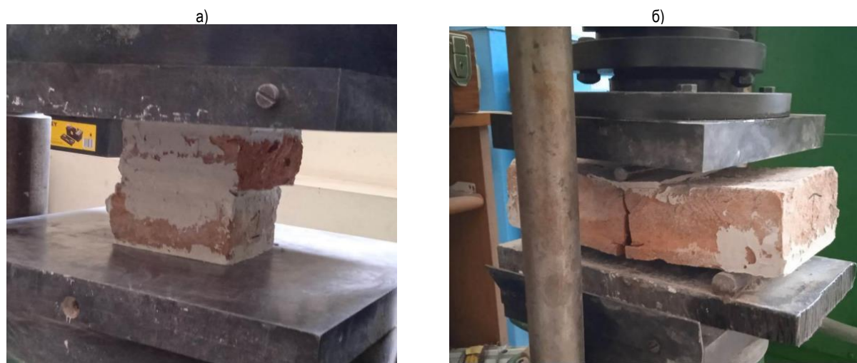
а) сжатие; б) изгиб Рисунок 1 – Испытания кирпича
