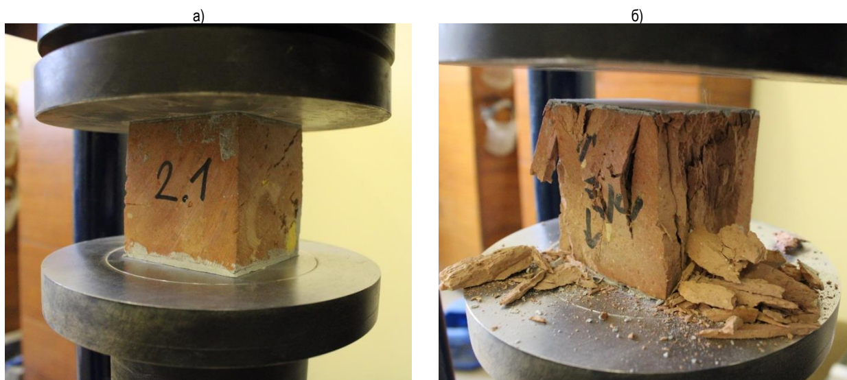
а) общий вид образца; б) характер разрушения Рисунок 2 – Испытание керамических кубов
