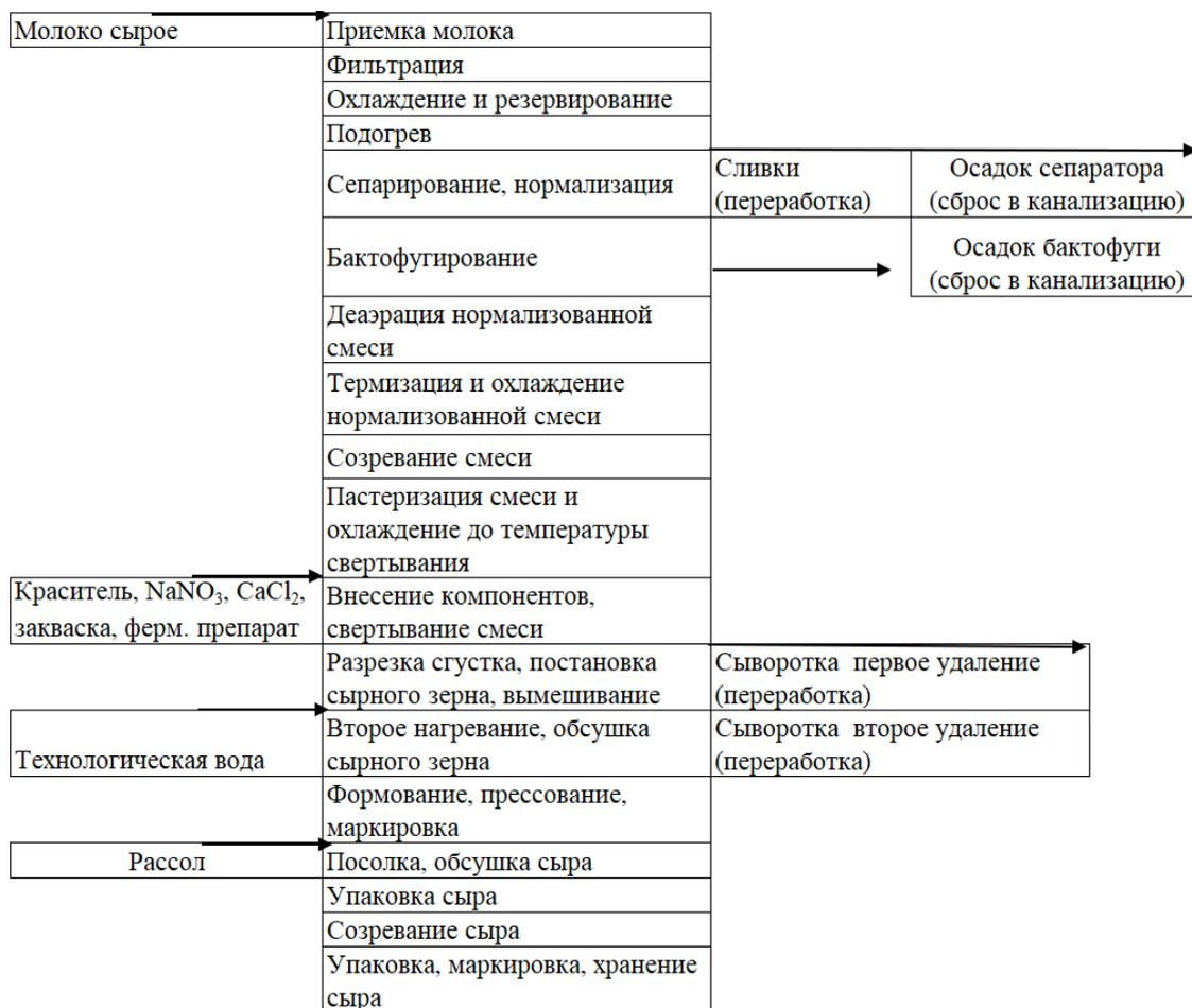
Рисунок 1 – Общая технологическая схема производства твердых (полутвердых) сыров
