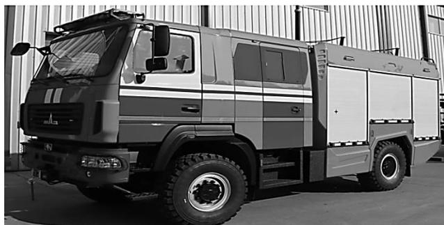
**Рисунок 3 – Автоцистерна АЦ-5,0-40 (модель 5309), эксплуатируемая в УПАСЧ УГЗ**
