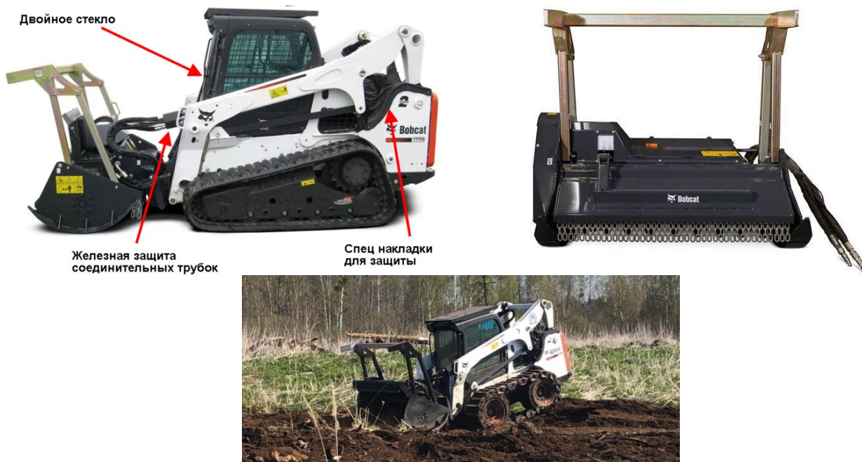
Рисунок 2 – Мобильная дробилка (кусторез) «Bobcat» на базе погрузчика «Bobcat» с бортовым поворотом S770 (общий вид и работа в полевых условиях)
