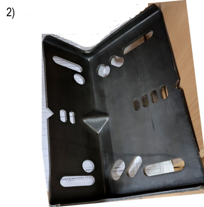
1 – 3D-модель проектируемого кронштейна; 2 – фото реального объекта Рисунок 1 – Кронштейн 1010.05.00.002
