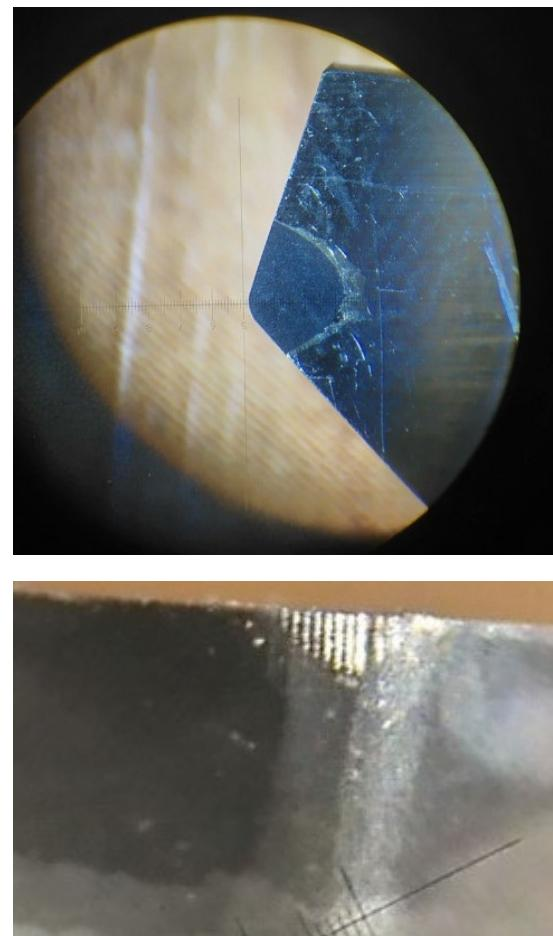
а) резец с напайной пластиной из композита cBN-Al;
