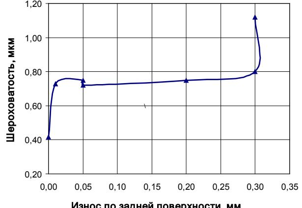
а) шероховатости обработанной поверхности от времени обработки;
