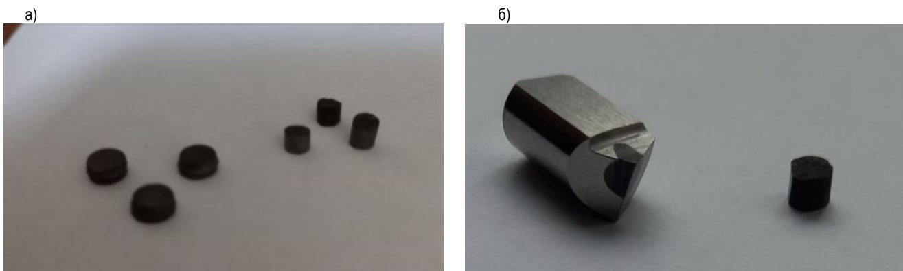
Рисунок 1 – а) пластины из сBN–А и сBN–wBN–AlB<sub>2</sub>/AIN изготовленные в ОИМ НАН Беларусь;
