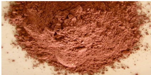
Рисунок 2 – Керамзитная пыль ЗАО «Лидский завод керамзитового гравия»
